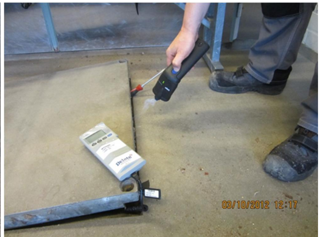
kuva 6 Alustatila imaisee merkisavun. Etualalla on HMI 41 -näyttökoje.
