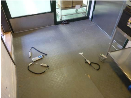
Kuvat 16 ja 17. Esimerkki tuulikaapin 155 lattiapäällysteen alapuoleisista suhteellisen kosteuden mittauksista (viiltomittauksista) sekä porrashuoneen 159 seinän porareikämittauksesta.
