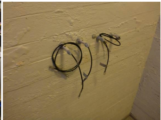
Kuvat 16 ja 17. Esimerkki tuulikaapin 155 lattiapäällysteen alapuoleisista suhteellisen kosteuden mittauksista (viiltomittauksista) sekä porrashuoneen 159 seinän porareikämittauksesta.
