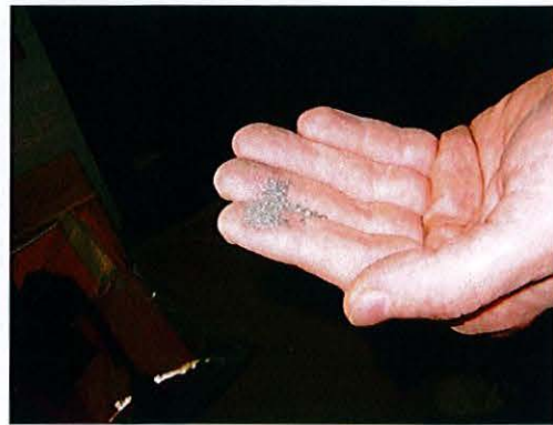
Kuva 2. Kanavan metallipurua ja -pölyä.
