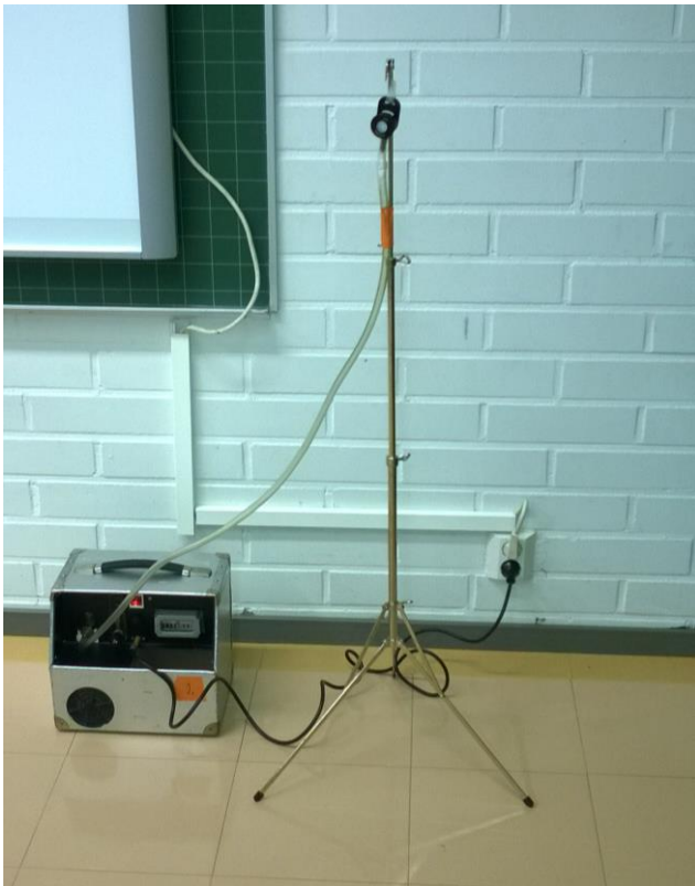
Kuvat 1, 2, 3. Variston koulun luokkatilassa 117 tutkittiin sisäilman lyijypitoisuutta kahden samanaikaisesti otetun näytteen avulla.
