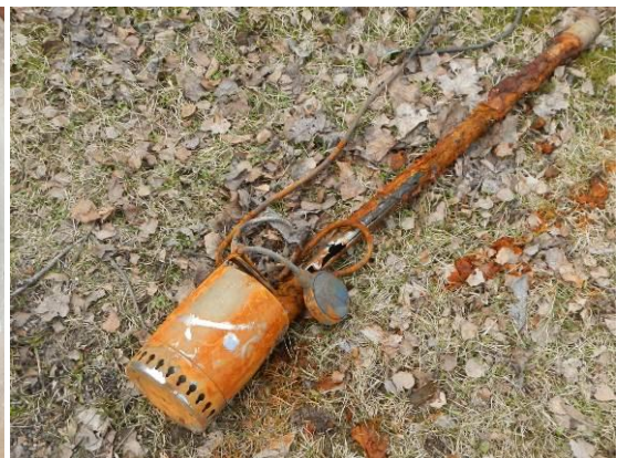
Kuva 36. Vanha pumppu, paineputki syöpynyt puhki.
