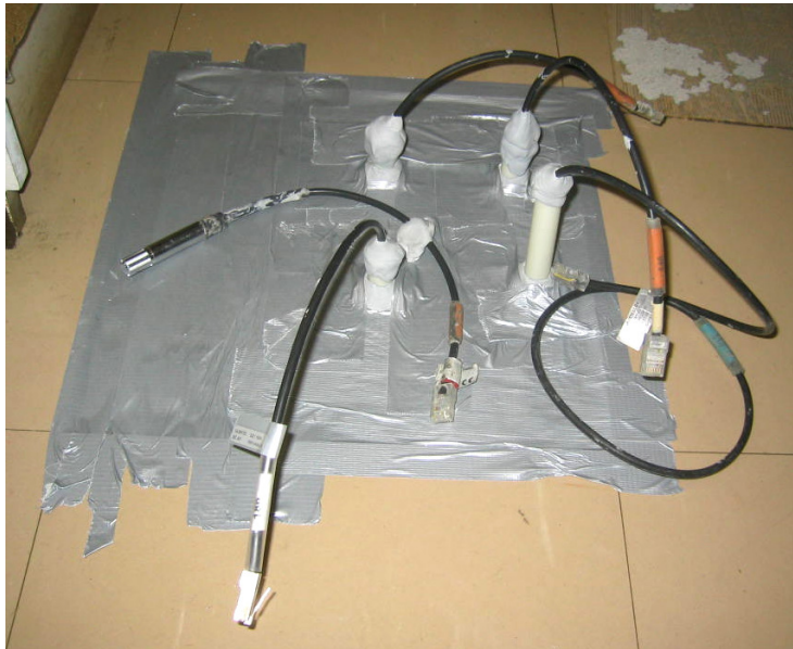
Kuva 5. Varastossa 126 rakennuksen keskialueella ollut porareikämittapiste 2. Mittapäät ovat asennettuina mittausreikiin ja betonin pinta on suljettu ilmastointiteipillä rakenteen pintaosien merkittävän kuivumisen estämiseksi mittausten aikana.
