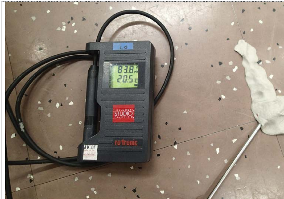
Kuva 27: Luokka 150, viiltomittaus pinnoitteen alta pintakosteusmittarin osoittamasta kosteimmasta kohdasta.
