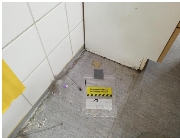
Kuva 9. OT3 huone 150. Materiaalinäyte muovimatosta kosteusalueelta.
