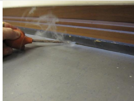
Kuva 7. Merkkisavukoe ikkunan alapuolelta lattianrajasta.
