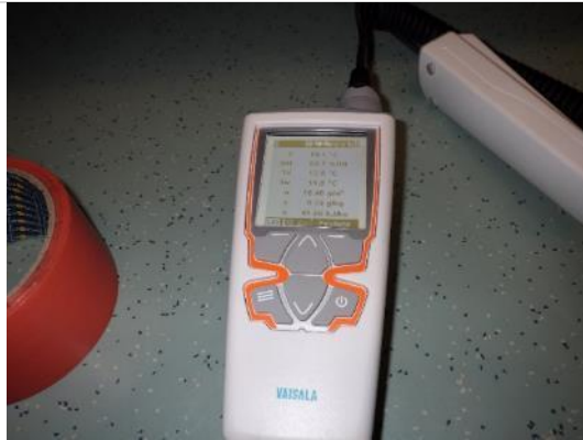
Kuva 23. Rakennekosteuden mittatulos RH 64% heti pinnoitteen alapuolella.
