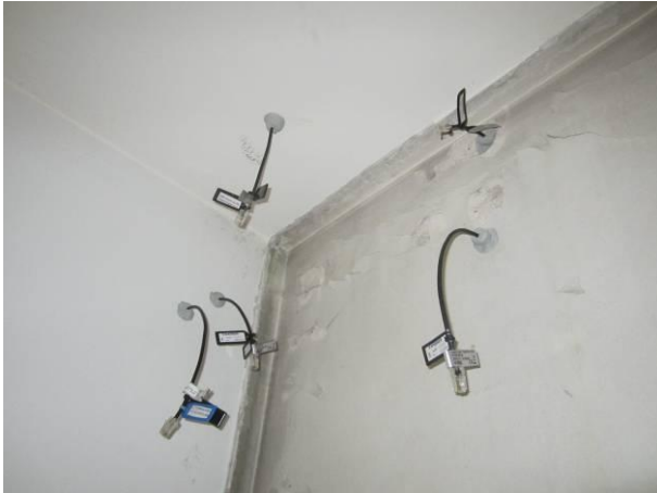
Kuva 3 Porareikämittaukset PRS2 jne ylänurkassa ja yläpohjaan PRK1
