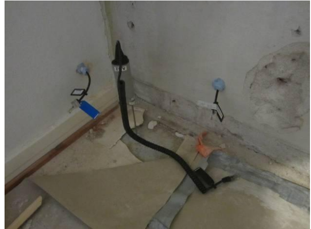
Kuva 4 Porareikämittaukset alanurkassa, PRS4, PRS7 ja PRL8
