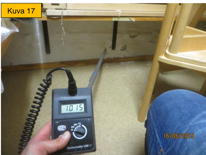
Kuva 17 ja 18. Luokan 1 vieressä olevassa portaassa alustilassa havaittiin kosteusjälkiä ja koholla olevia pintakosteuslukemia.
