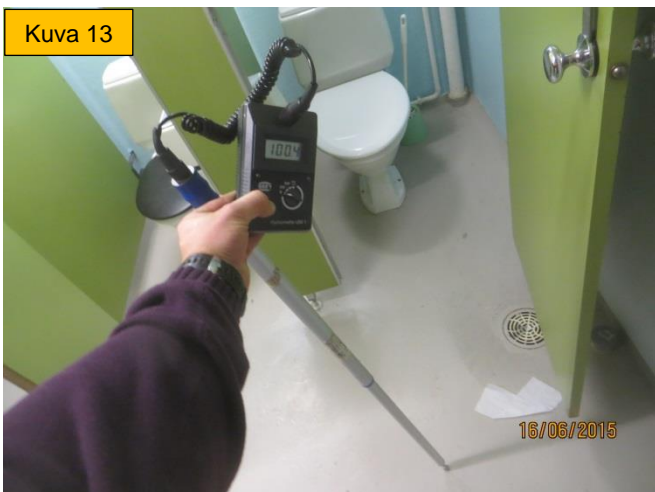
Kuva 13. Poikien WC-tilat. Pintakosteusmittauksissa havaittiin koholla olevia arvoja. Kuva 14. Yleiskuvaa WC-tiloista.
