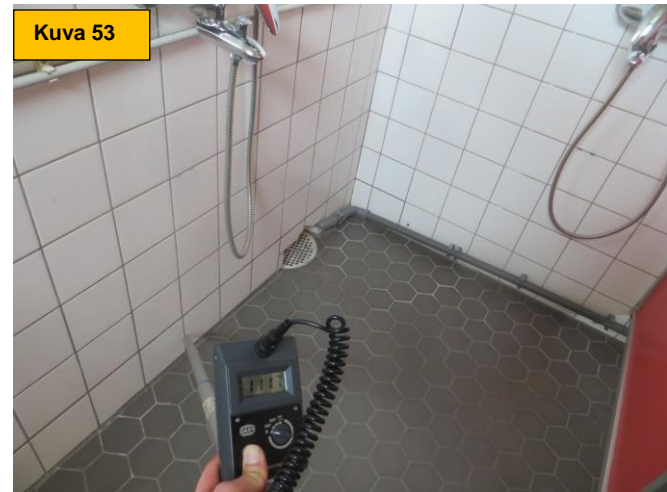
Kuva 52 ja 53. Liikuntasalin märkätila, pintakosteudet koholla seinien alaosilla. Yleisesti märkätilat ja pukuhuoneet ovat peruskorjausta vailla.
