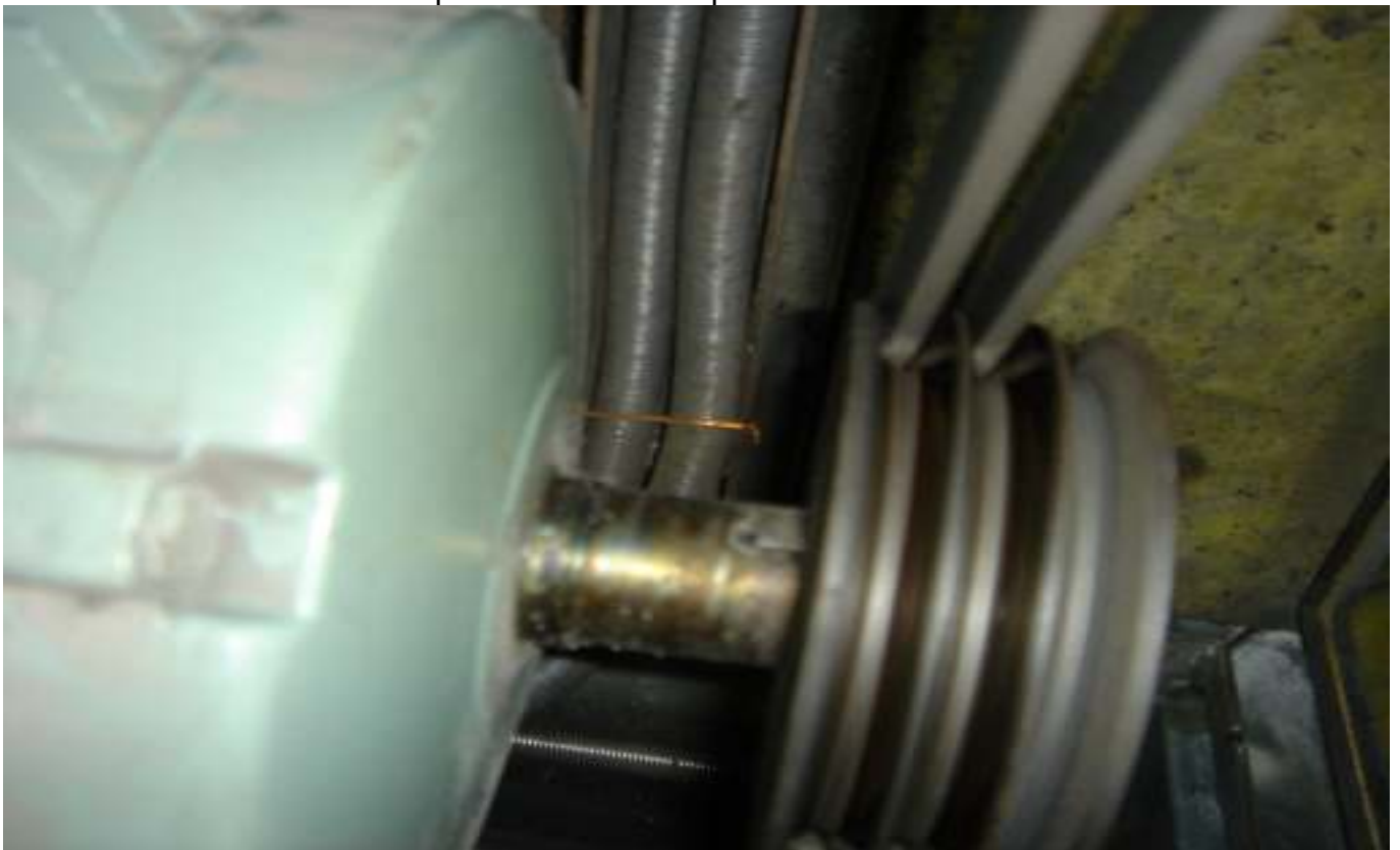
KUVA 10. Urapyörät ovat kuluneita ja uusinnan tarpeessa.
