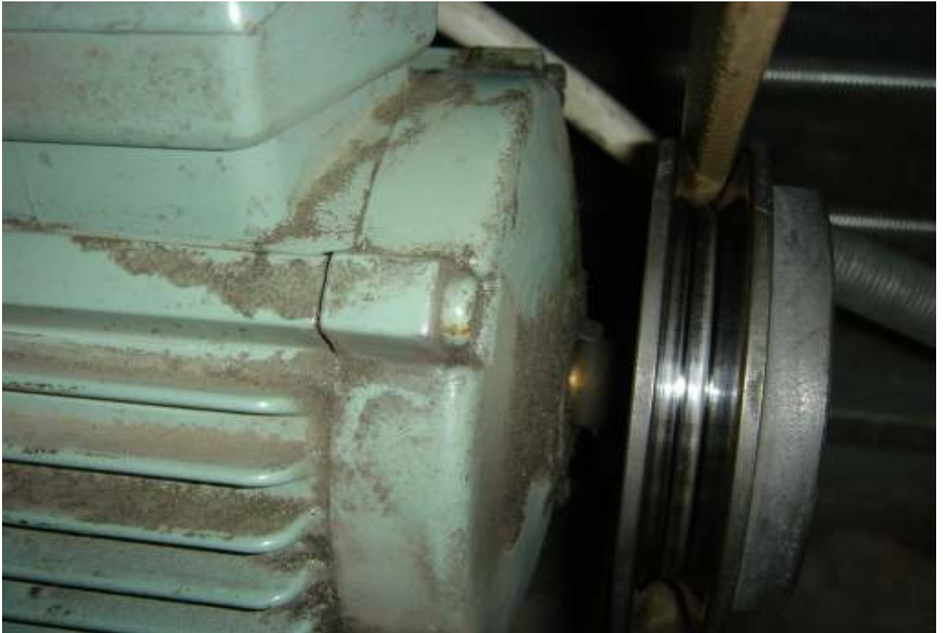
KUVA 20. Urapyörät ovat kuluneet ja uusinnan tarpeessa.
