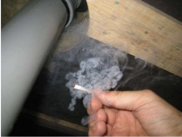
Kuva 13 Merkkisavutikuin kokeiltiin otosmaisesti läpivientien tiiviyksiä.
