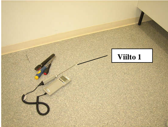
Kuva 3 Viiltokosteusmittaus muovimaton alta.
