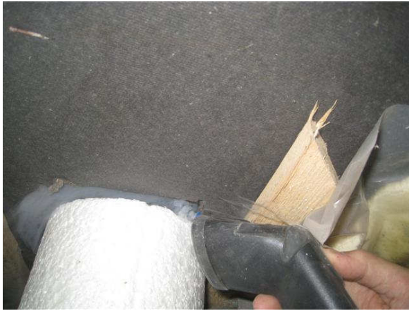
Kuva 19 Merkkisavulla kokeiltuna savu ei ilmaissut ilmavuotoa sisätilaan päin.
