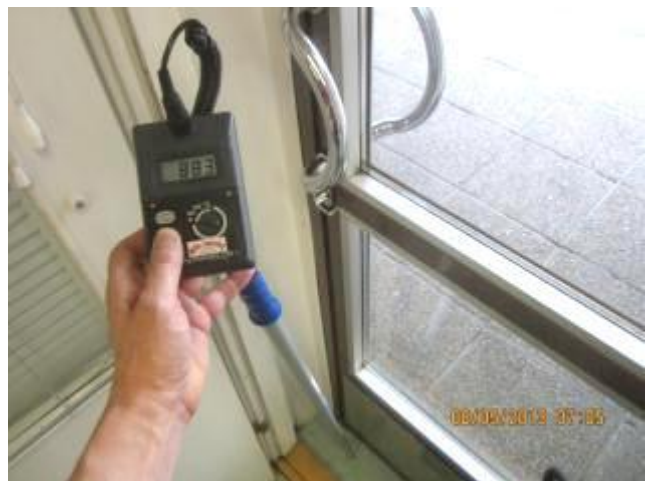
kuva 12 Taukhuoneen (14) sisäänkäynnin luota mitattiin koholla oleva pintakosteuslukema.
