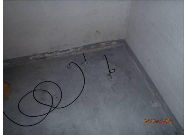
Kuva 10 Porareikämittauspiste MP2 kellarin pienessä varastotilassa.
