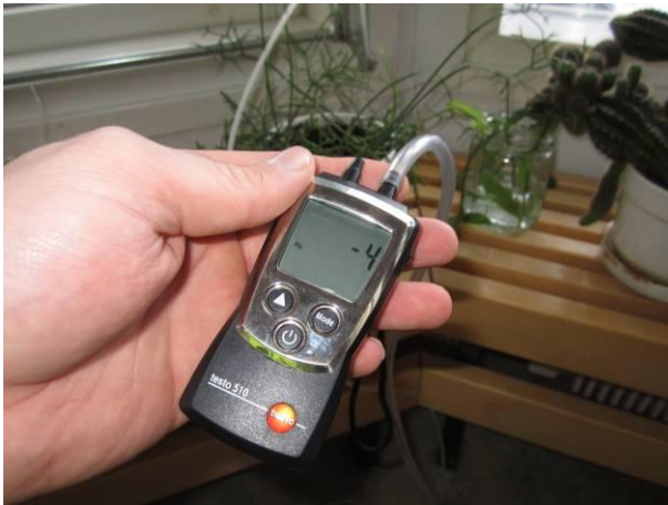
Kuva 3 Sisäilma oli ulkoilmaan nähden 4 Pascalia alipaineinen, eli ok.
