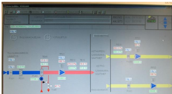
Kuva 8. Keittiön tuloilmakoneen TK03 säätökaavio valvomografiikalla.
