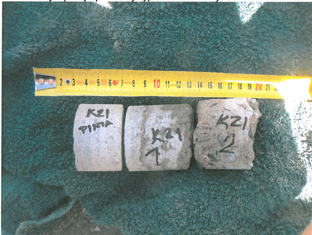
Kuva 8. Porrasnäyte K21. Pintalaatta irtosi kiinnityslaastin kohdalta porattaessa.
