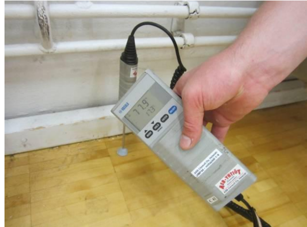
Kuva 37. Salin maanpaineseinän kosteus koholla PR3., myös pintakosteudet olivat koholla Kuva 38. Eristetilan kosteus koholla maanpaineseinän vieressä VT6/ pilari C1.
