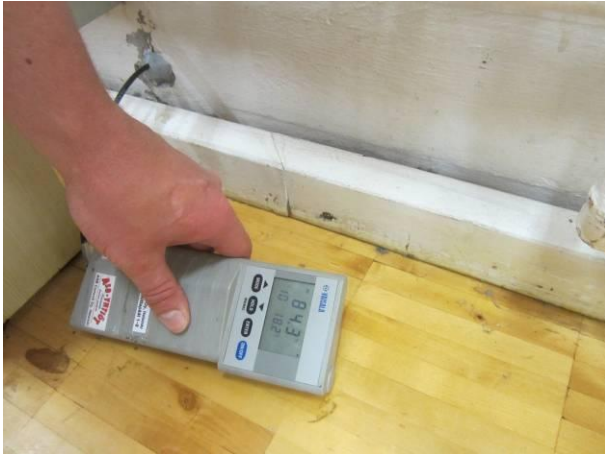
Kuva 37. Salin maanpaineseinän kosteus koholla PR3., myös pintakosteudet olivat koholla Kuva 38. Eristetilan kosteus koholla maanpaineseinän vieressä VT6/ pilari C1.
